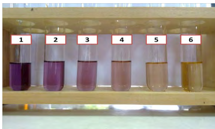
Gambar 2 Hasil Pengujian Daya Antioksidan dengan Metode DPPH secara Kualitatif (reaksi warna) Ekstrak Etanol Kayu Secang Merah
