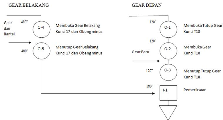
**Gambar 2.** *Operation Process Chart Gear dan Rantai*
