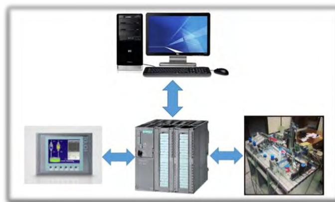
Gambar 2. Ilustrasi Sistem Kontrol MPS
