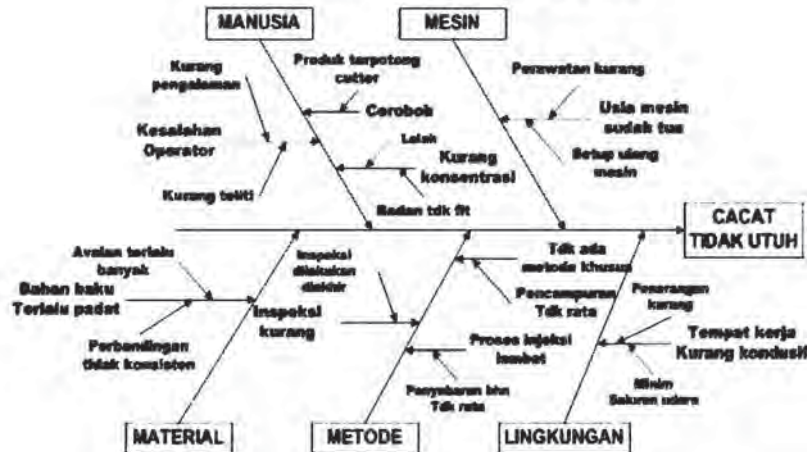
Gambar 11 Diagram Sebab Akibat Untuk Cacat patah Sumber: brainstorming dengan pihak CV. X
