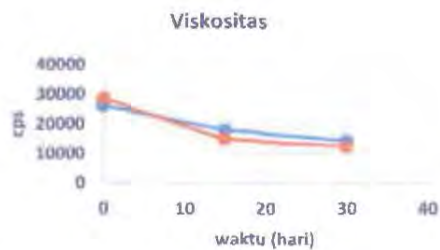
Gambar 5. Profil Hasil Pengamatan Viskositas Rata-Rata \pm SD Sediaan Krim Formula II dan III dari Hari ke-0 sampai hari ke-30 menggunakan Brookfield tipe Cone and Plate dengan Spindle 41 pada rate of shear 0,5; 1; 2; 4; dan 5 rpm terhadap Waktu Penyimpanan
