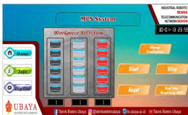
Gambar 4. Tampilan Kombinasi Benda Kerja pada HMI
