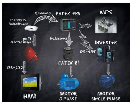
Gambar 2. Ilustrasi Sistem Kontrol MPS
