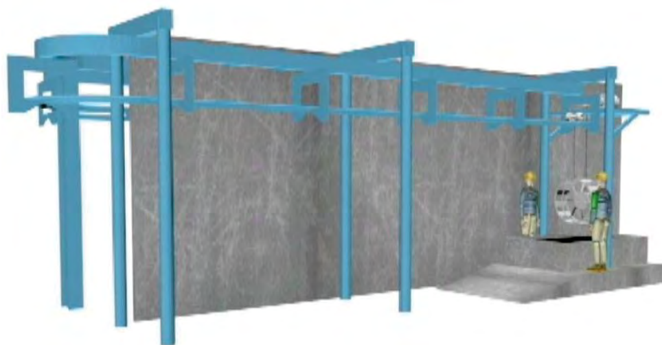
Gambar 4. Rancangan 3D Rel Gantung dan Katrol
