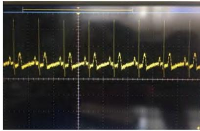
Gambar 7. Sinyal Output Sensor AD8232 dengan Denyut 60 BPM
