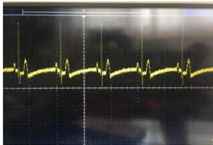
Gambar 7. Sinyal Output Sensor AD8232 dengan Denyut 40 BPM
