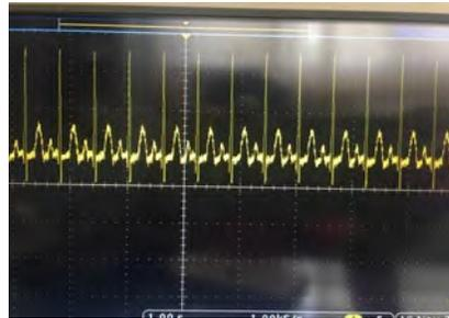
Gambar 8. Sinyal Output Sensor AD8232 dengan Denyut 100 BPM
