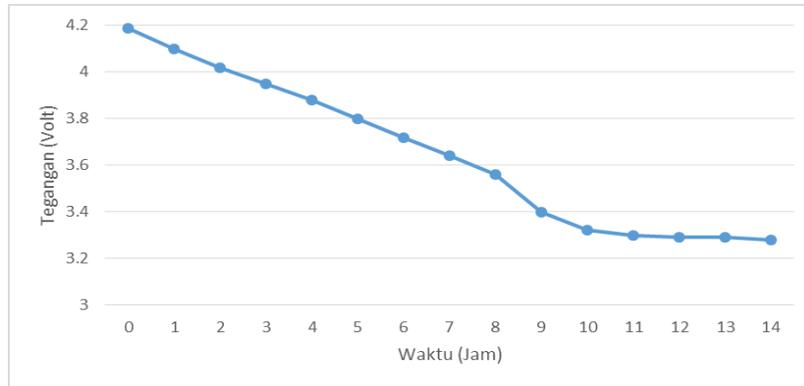
**Gambar 15. Diagram Hasil Pengukuran Tegangan Baterai LiPo**
