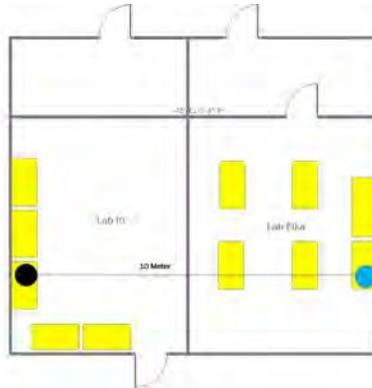
Gambar 10. Denah Pengujian Jarak Bluetooth dengan Hambatan
