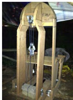
Gambar 13. Pembuatan rangka dan mekanisme katrol
