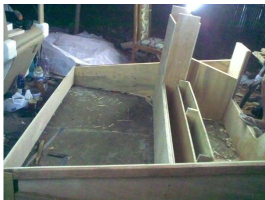
Gambar 13. Potongan plywood membentuk meja yang disusun tidur
