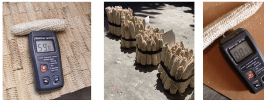
Gambar 11. Menghitung kelembapan bonggol jagung Sumber: Dokumentasi penulis
