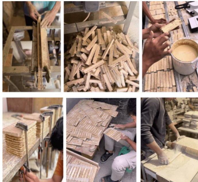
Gambar 12. Proses pembuatan papan lapis Sumber: Dokumentasi penulis
