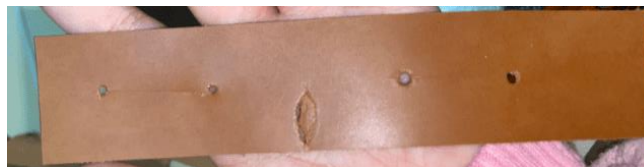
Gambar 5. Kulit mengalami kegagalan proses produksi, Sumber: Dokumentasi Penulis,2024
