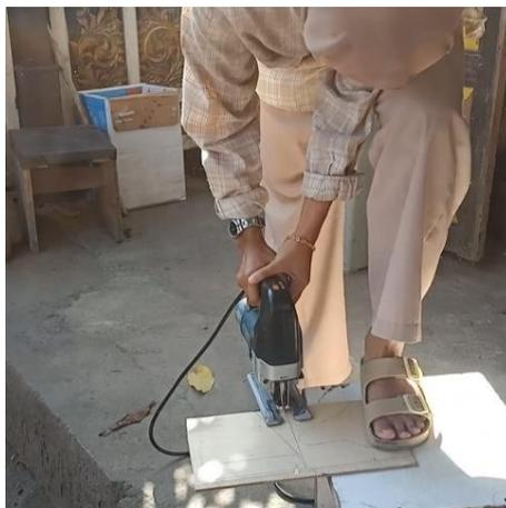
Gambar 5. Proses pemotongan triplek menggunakan jigsaw
