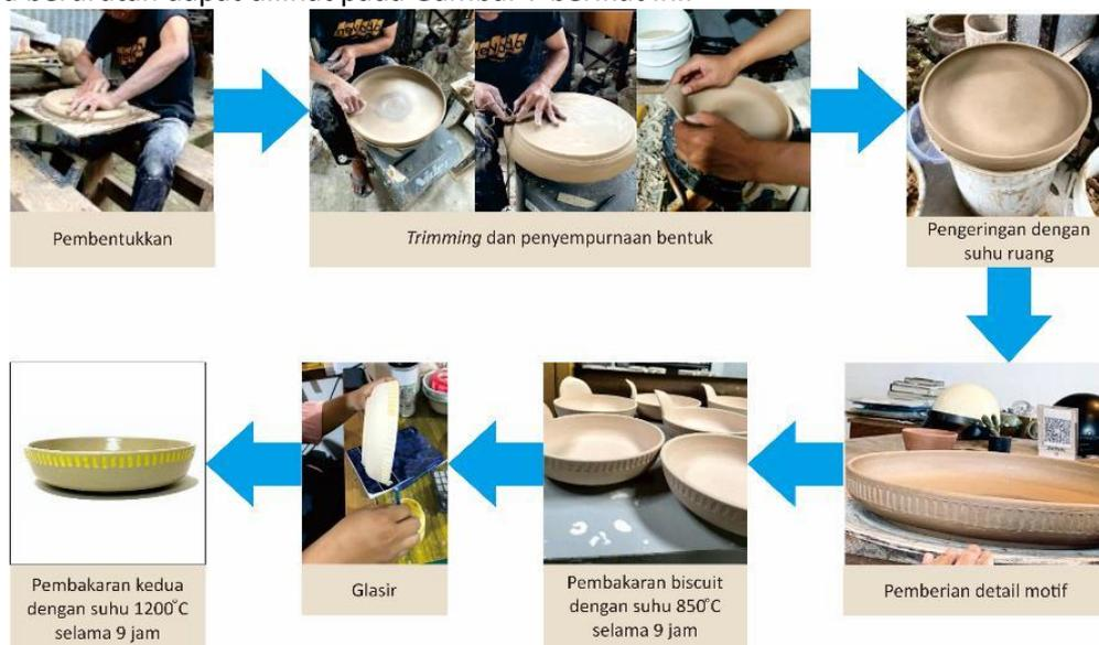
Gambar 6. Proses pembuatan purwarupa.
