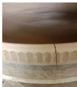
Gambar 7. Retak pada *dulang* karena proses pengeringan yang dipercepat dengan semburan api.
